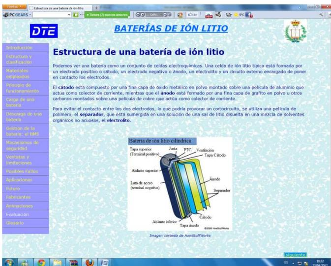
Figura 2. Estructura de una batería Litio-Ión
